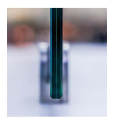
**Fineo 6 mit U** $_{\rm g}$ **-Wert 0,7 W/m** $^2$ **K** Zwei nur 3 mm dicke Glasscheiben mit hochisolierender Beschichtung, dazwischen eine Vakuumschicht von 0,1 mm, um Wärme- und Schallleitung zu unterbinden.
