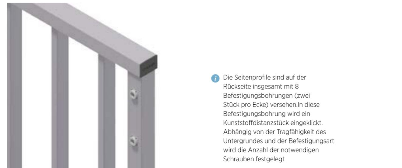
**i** Die Seitenprofile sind auf der Rückseite insgesamt mit 8 Befestigungsbohrungen (zwei Stück pro Ecke) versehen. In diese Befestigungsbohrung wird ein Kunststoffdistanzstück eingeklickt. Abhängig von der Tragfähigkeit des Untergrundes und der Befestigungsart wird die Anzahl der notwendigen Schrauben festgelegt.
