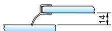
Art.-Nr. 8858KU0-8-2010 Art.-Nr. 8858KU0-8-2500 für 6 und 8 mm Glas für ein einseitig nach außen öffnendes Duschtürband
