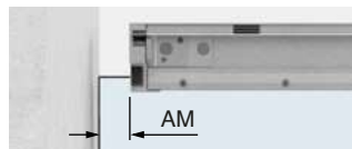
Laufschiene auf das Seitenteil geklemmt Weitere Infos finden Sie im technischen Katalog auf Seite 78
