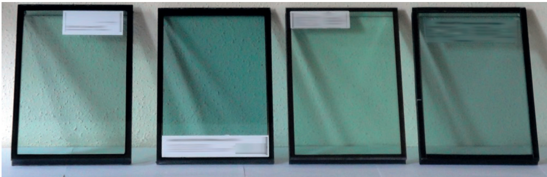
BILD 16 Bemusterung: spektral unterschied- liches Verhalten verschiedener Gläser mit ähnlicher Licht- transmission T_{vis,D65} , u- und g-Wert.
