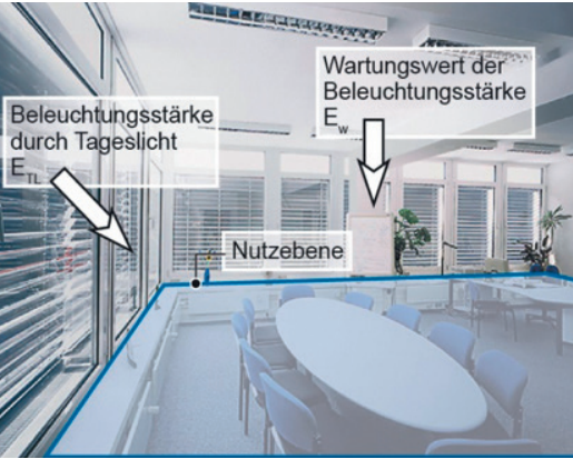
BILD 6 Zur Definition der relativen Nutzbelichtung (Tageslichtautonomie) zur Bewertung der Tageslichtversorgung in Innenräumen.
