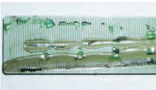
Abb. 28: Klotz nach schädlichen Wechselwirkungen
