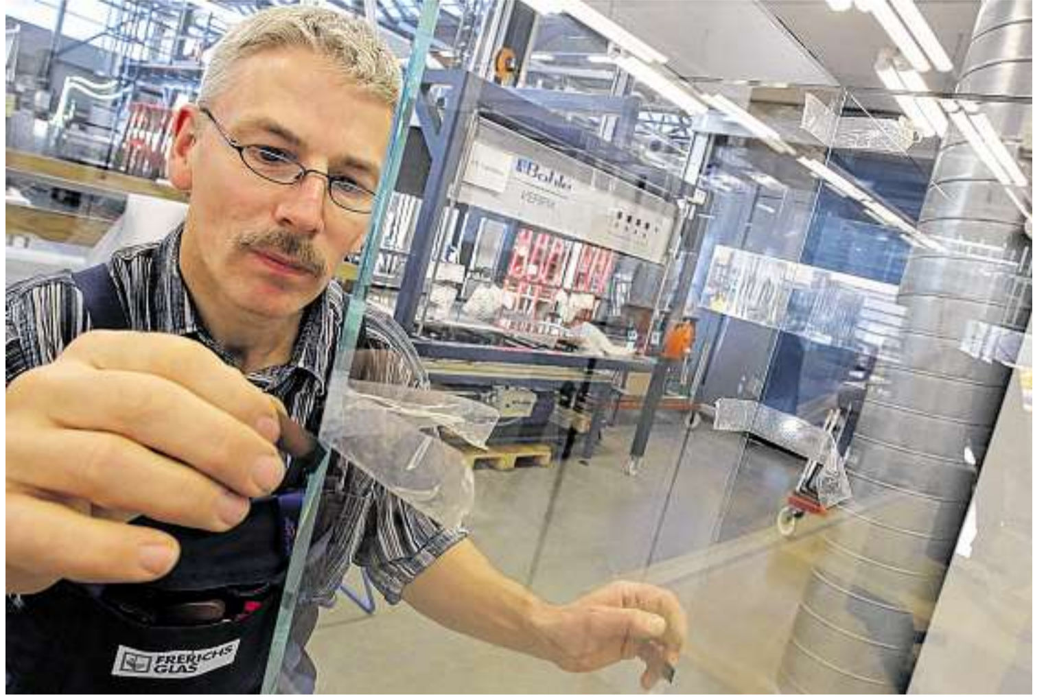
Thomas Zilinski justiert Glasplatten einer Vitrine. Dafür braucht er eine ruhige Hand und ein gutes Auge, da er genau die richtige Menge an Klebstoff verarbeiten muss.
