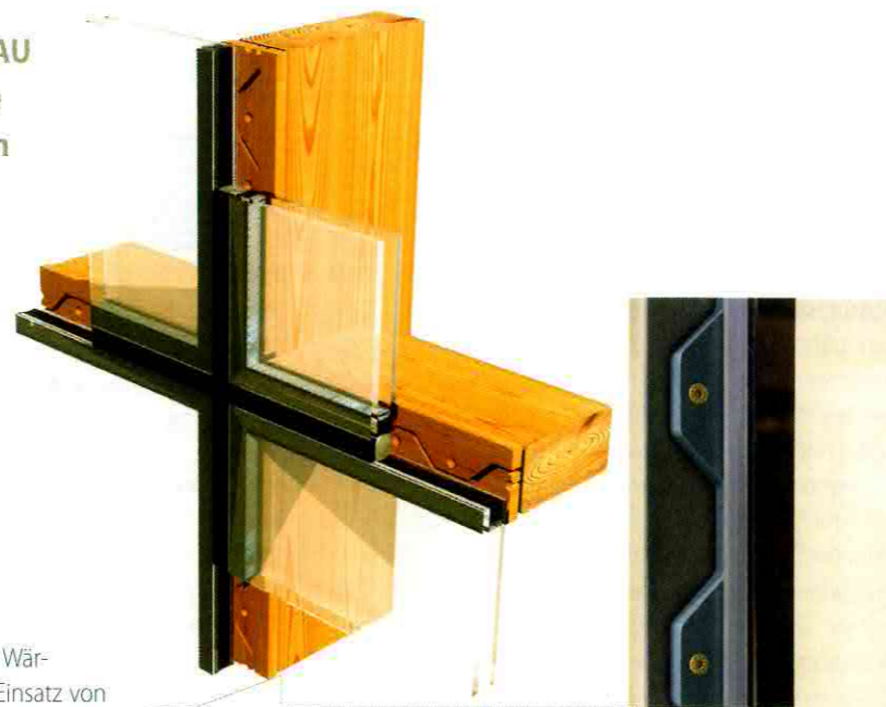
Schematischer Aufbau der geklebten Holz-Glas-Fassadenkonstruktion von Uniglas.
